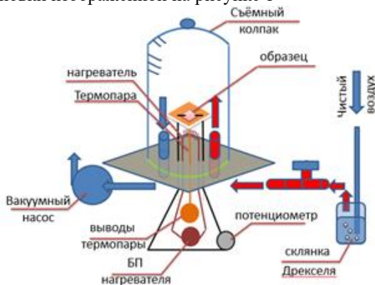
Рис. 1. Установка для изучения сенсорных свойств по отношению к газам-восстановителям.
